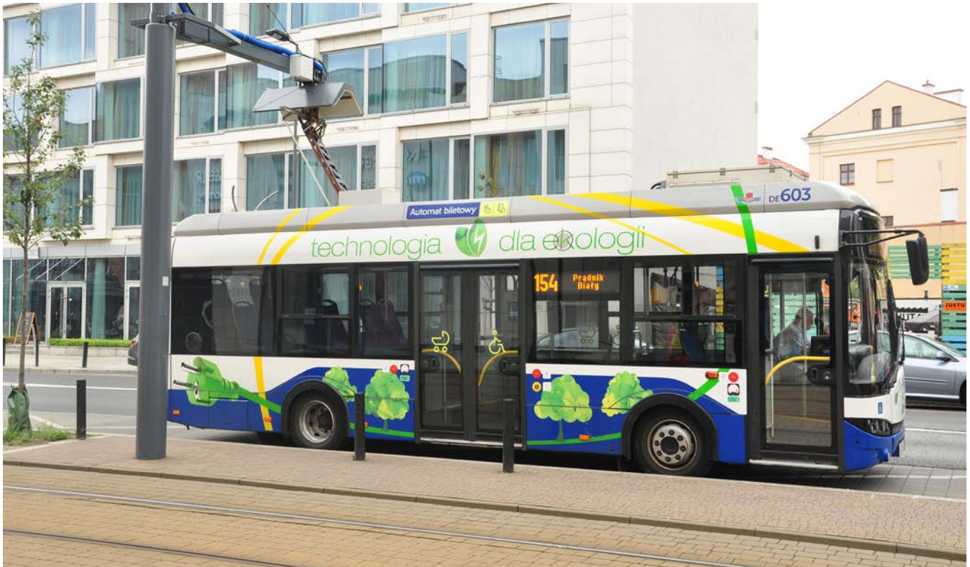
Електробус Solaris Urbino 8,9 LE під час швидкого заряджання на вулиці у Кракові (2019)
